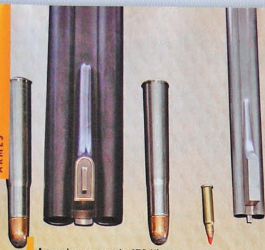
A gauche, canons de 470 Nitro Express, à droite ceux de l'express Hummingbird en calibre 17 Hornady à percussion annulaire.
