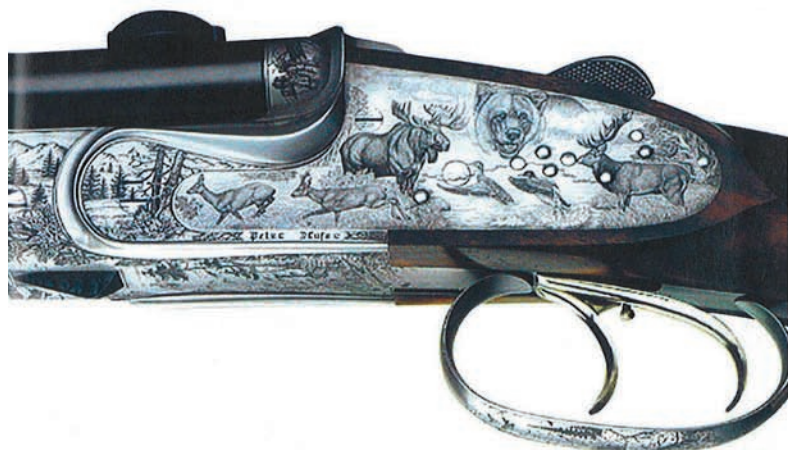
Ez a meglepő, oldallakatos fegyver egy igen eredeti drilling, három különböző kaliberű csövel: 8x75 RS, 6,5x65 R és .410 Mag.
