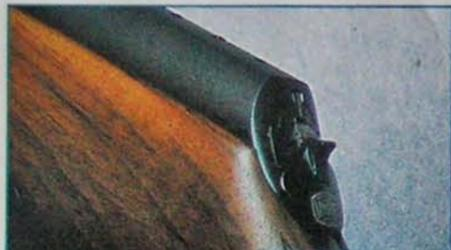
Zum Spannen des M97 drückt man den Spannkopf herunter (l.). Im entspannten Zustand ragt er über das Schloßchen heraus (u.)
