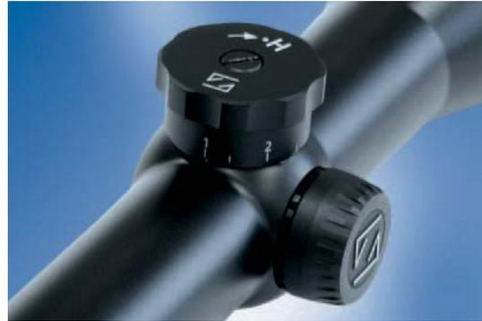
*Um auf die gewünschte Distanz von 100, 150, 200, 250, 300 Metern Fleck zu schießen, muss der Ring lediglich auf die entsprechende Markierung 1, 1.5, 2, 2.5 oder 3 gedreht werden.*
